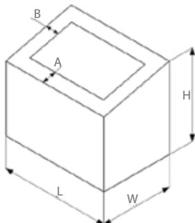
Wskazanie stref zwiększonych sił ssawnych wiatru określa się na podstawie podstawowych wymiarów budynku (rys.1), gdzie:
